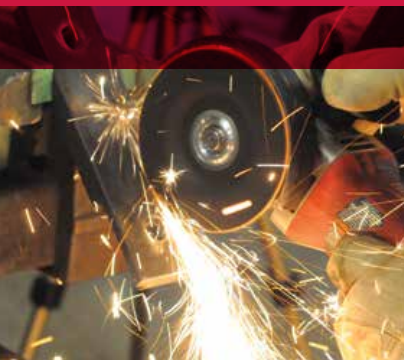
Corte de una ranura en V en material en barra con un disco de corte Tiger.
