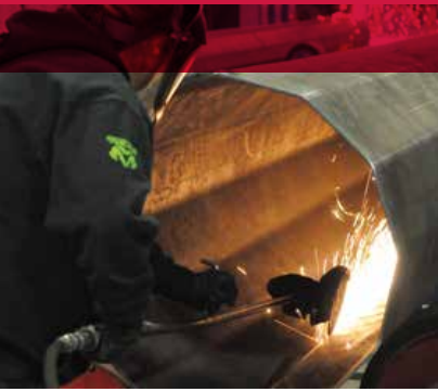
Remoción de soldaduras con el disco combo Tiger.
